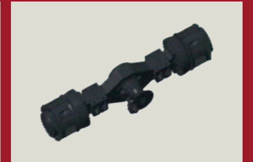
İki kademeli yavaşlatma ile ağır hizmet tipi çekiş aksı; Bakım gerektirmeyen ıslak fren; Hidrolik serbest bırakma yaylı park freni güvenli ve güvenilir bir şekilde sağlar.
