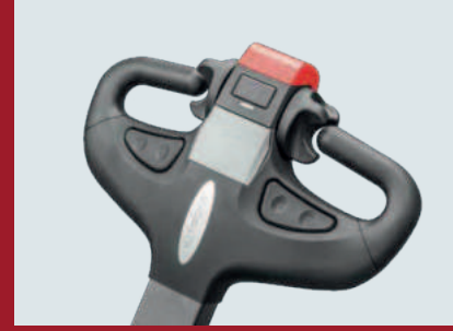
Modüler timon basit ancak güvenilir ve estetik olarak hoştur. İçindeki tüm parçalar ayrı ayrı değiştirilebilir ve tüm işlemler tek el ile kolayca gerçekleştirilebilir.
