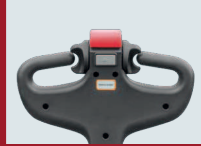
Dik duran timon çalışma fonksiyonu, konteyner gibi sınırlı alanlarda çalışmasına izin verir.
